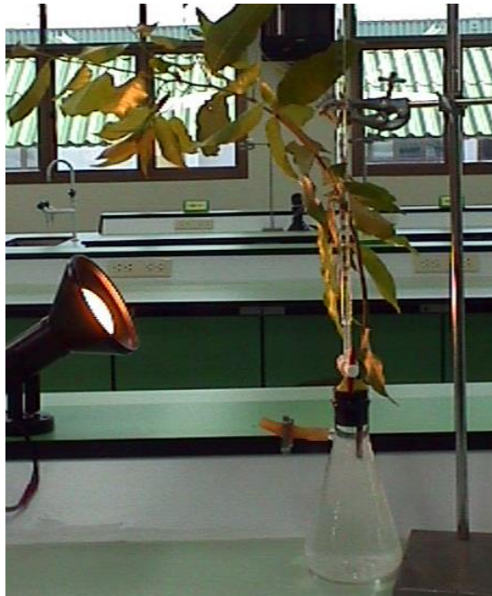
ภาพแสดง : ชุดการทดลองวัดอัตราการคายน้ำของน้ำ (Photometer)
