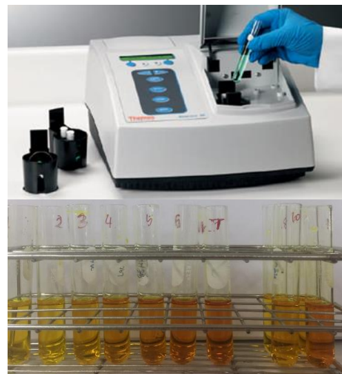
ภาพที่ 2 : แสดงการทดสอบการหาปริมาณคาร์โบไฮเดรต โดยเทคนิควิธีสเปกโตรโฟโตเมทรี
