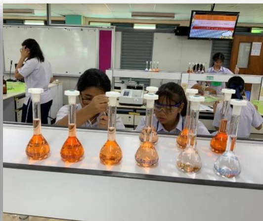
ภาพแสดง : การหาค่าปริมาณเหล็กในน้ำตัวอย่างโดยเทคนิคสเปกโทรโฟโตเมทรี
