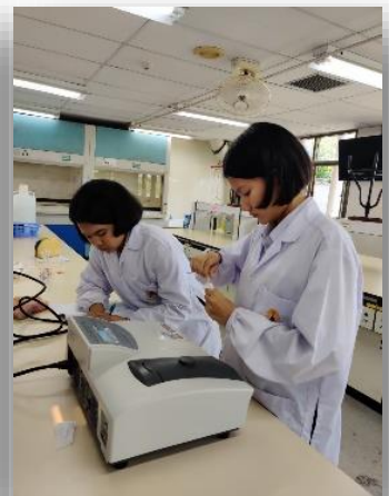
ภาพแสดง : การหาค่าปริมาณเหล็กในน้ำตัวอย่างโดยเทคนิคสเปกโทรโฟโตเมทรี
