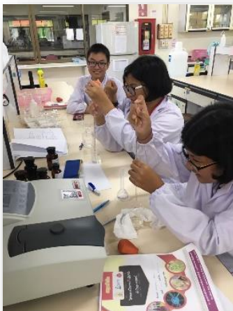
ภาพแสดง : การหาค่าปริมาณเหล็กในน้ำตัวอย่างโดยเทคนิคสเปกโทรโฟโตเมทรี
