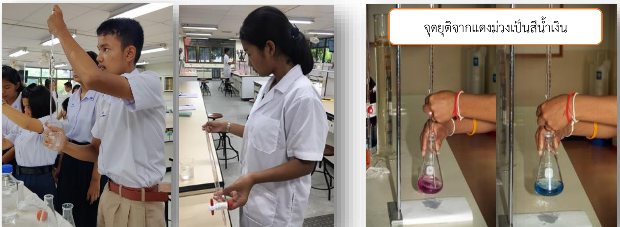
ภาพแสดง : การวิเคราะห์หาความกระด้างของน้ำ
