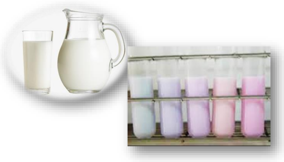
ภาพแสดง : การตรวจสอบจุลินทรีย์ในน้ำนมโดยวิธี Resazurin Reduction Test
