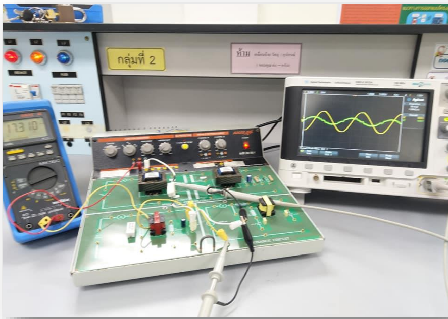
ภาพแสดง : การทดลองวงจร RLC ไฟฟ้ากระแสสลับ
