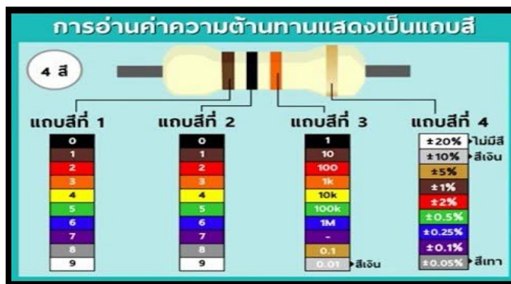
ภาพที่ 20 การอ่านค่าความต้านทานแสดงเป็นแถบสี
