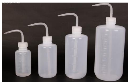
ภาพที่ 3.24 ขวดฉีดน้ำกลั่น (Wash bottle)
