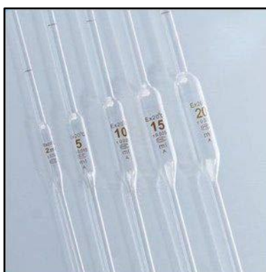
ภาพที่ 3.15 ปิเปตแบบวัดปริมาตร (Volumetric pipette)
