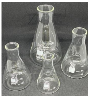
ภาพที่ 3.12 ขวดรูปชมพู่ (Erlenmeyer flask หรือ conical flask)
